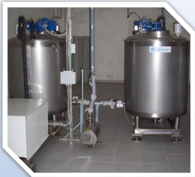
O Sistema para Ingredientes líquidos, desenhado de acordo com as necessidades do cliente, preparado para a produção ou armazenamento de Água gelada, Leveduras líquidas
