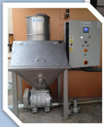
Sistema de enchimento dos silos através de uma estação de carga
