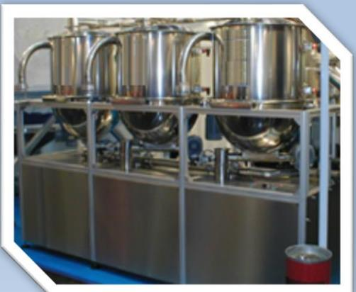
Sistema de Micro-Silos, desenhado para a utilização de dosagens precisas de Micro-Ingredientes usadas nas receitas
